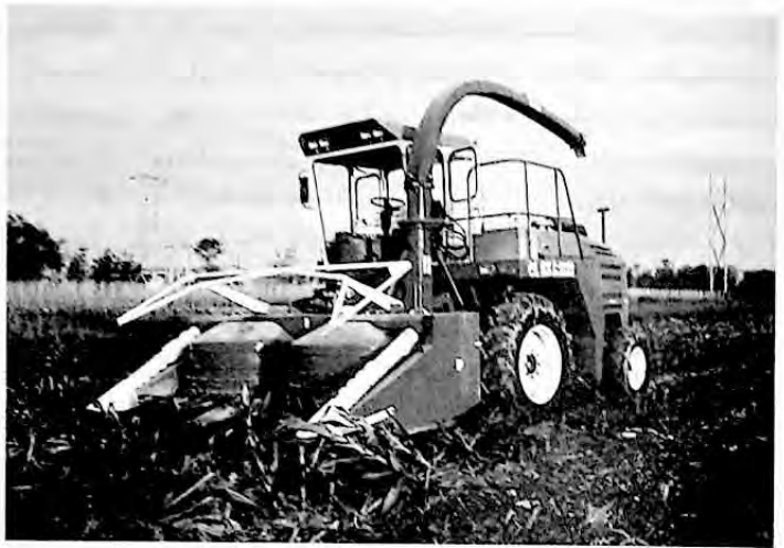
2003 - يىلى شىنجاڭ ماشىنىسازلىق تەتقىقات ئورنى يېڭىدىن تەتقىق قىلىپ ياساپ چىققان سىلوسلىنىدىغان زىرائەتلەرنى يىغىدىغان 9QSZ-3000 تىپلىق ئۆزى يۈرەر ھوسۇل يىغىش ماشىنىسى مەشغۇلات ئۈستىدە.
